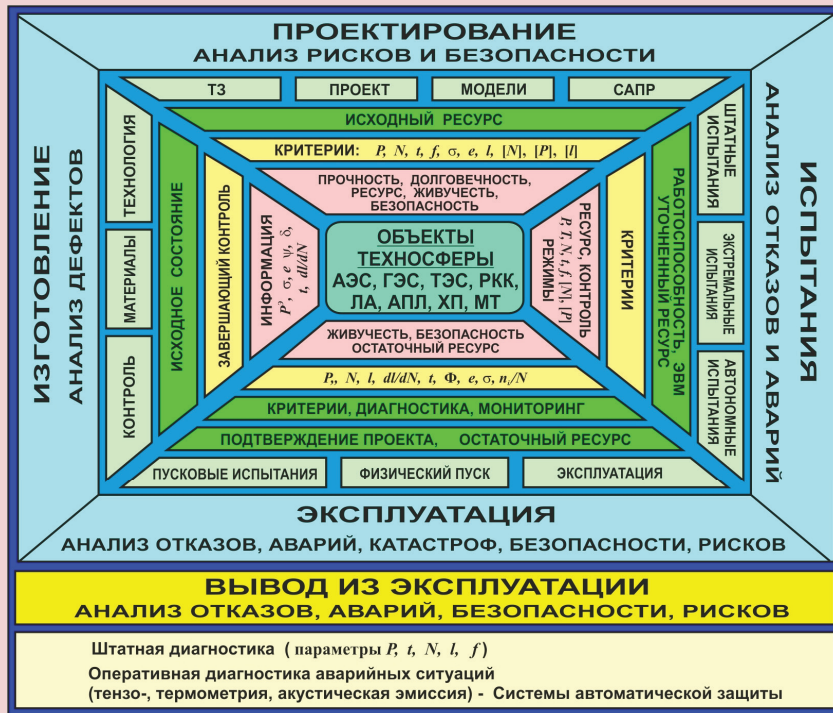
Рисунок 10. Структурная схема анализа прочности и безопасности объектов техносферы на различных стадиях жизненного цикла
